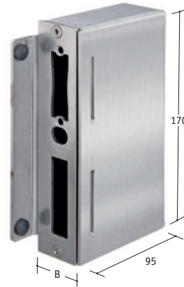
AMF Gegenkasten V2A, rechts/links verwendbar, feingeschliffen, geeignet für Schlösser mit Breite (B): 30 und 40 mm. Vorgefertigt für elektronischen Türöffner, passender elektrischer Türöffner: Art. Nr. 96 30 07
