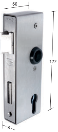
AMF Einsteckschloss mit Schlosskasten V2A, 1-tourig, Nuss: 8 mm, Entfernung: 72 mm, Falle: 2 mm vorstehend, Riegel: 3 mm vorstehend
