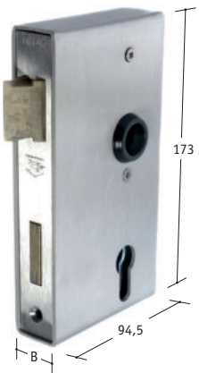
AMF Einsteckschloss mit Schlosskasten V2A, 2-tourig, Nuss: 8 mm, Oberfläche feingeschliffen, Edelstahlstulp, Schloss verzinkt, Falle & Riegel aus Messing
