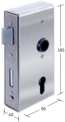
Einsteckschloss mit Kasten V2A, 2-tourig, ungeschliffen, Nuss: 8 mm, Entfernung: 72 mm
