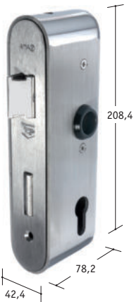
AMF Design-Schlosskasten V2A, 1-tourig, Nuss: 8 mm, Entfernung 72 mm, Falle: 2 mm vorstehend, Riegel: 3 mm vorstehend
