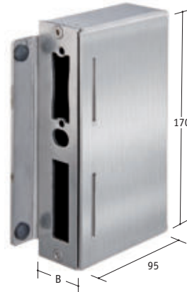
Gegenkasten V2A, rechts/links verwendbar, feingeschliffen, geeignet für Schlösser mit Breite (B): 30 und 40 mm. Vorgefertigt für elektronischen Türöffner, passender elektrischer Türöffner: Art. Nr. 96 30 07
