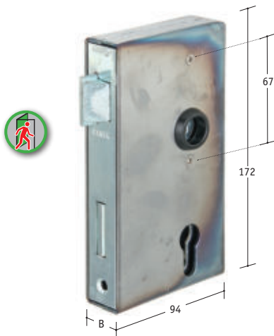
Anti-Panikschloss + Kasten, Nuss einteilig, Dorn 60 mm, Entfernung 72 mm, Nuss 9 mm, mit Wechsel, mit Panikfunktion
