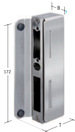
Gegenkasten V2A, oberflächenpoliert, rechts & links verwendbar, für Schlösser mit Breite 30 und 40 mm geeignet. Vorgefertigt für elektronischen Türöffner, passender elektrischer Türöffner: Art. Nr. 96 30 07
