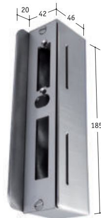
Anschlagkasten , inkl. Schließblech, Kastengehäuse mit Sollbruchstellen, Schließblech passend für elektrischen Türöffner Art. Nr. 963007 (s. S. 236). Durch Drehen des Schließbleches geeignet für Schlosskästen 30 & 40 mm, passend für Serie 55 & 60.
