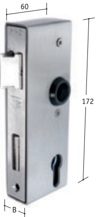
Einsteckschloss mit Schlosskasten V2A, 1-tourig, Nuss: 8 mm, Entfernung: 72 mm, Falle: 2 mm vorstehend, Riegel: 3 mm vorstehend
