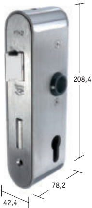
Design-Schlosskasten V2A, 1-tourig, Nuss: 8 mm, Entfernung 72 mm, Falle: 2 mm vorstehend, Riegel: 3 mm vorstehend
