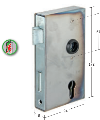
Anti-Panikschloss + Kasten, Nuss geteilt, Dorn 60 mm, Entfernung 72 mm, Nuss 9 mm, ohne Wechsel, mit Panikfunktion
