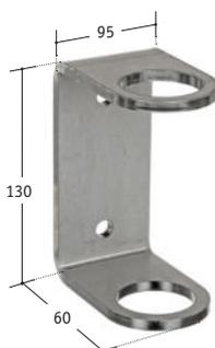
Wandbefestigung, Stahl roh, für Rohr ∅ 42,4mm, Material 6 mm
