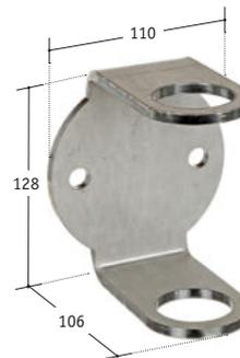
Wandbefestigung, Stahl roh, für Rohr ∅ 42,4mm, Material 6 mm
