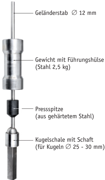
Massivkugelsetzwerkzeug, für Massivkugeln \varnothing 25 - 30 mm und Stäbe \varnothing 12 mm
