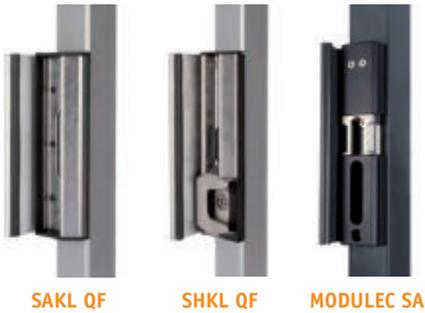
Elektrisches Schloss mit Aluminium-Gehäuse & Edelstahl-Mechanismus. Wenn das Schloss unter Strom steht, werden die Drücker blockiert. Dank der Möglichkeit die Riegel um 20mm zu verstellen, können Sie das Schloss genau auf den Anschlag einstellen und so für eine optimale Verriegelung sorgen. Ein massiver Edelstahl-Schlossriegel mit einer 23 mm-Tiefenverriegelung garantiert eine sichere Schließung.
