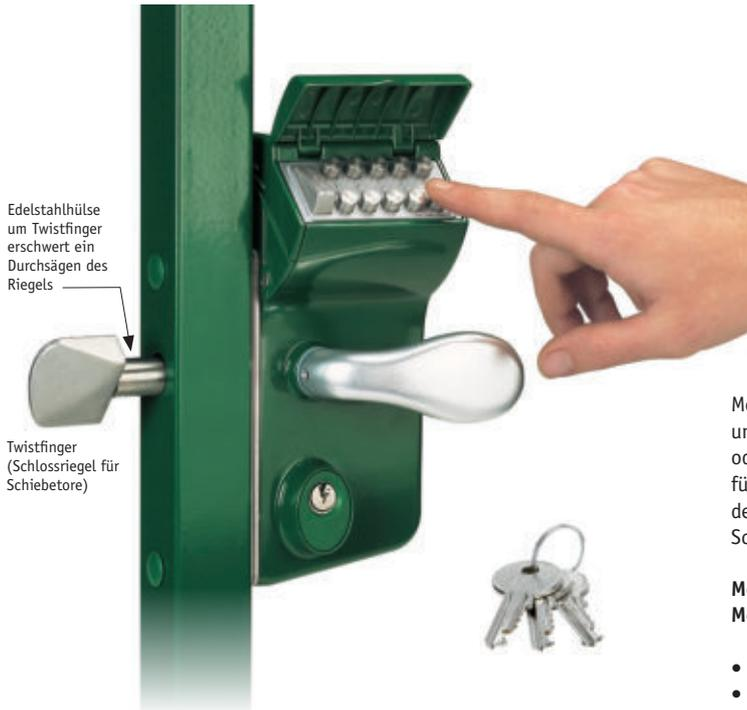
Mechanisches Codeschloss für Schiebetore mit Aluminium-Gehäuse und Edelstahl-Mechanismus. Dadurch, dass dieses Schloss ohne Strom oder Batterie funktioniert, bietet es eine einfache und schnelle Lösung für Schiebetore mit Zugangskontrolle. Die spezielle Twistzunge und der bewegliche Anschlag stellen eine einwandfreie Schließung Ihres Schiebetores sicher.
