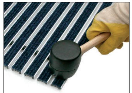
3.) Neue Ripsstreifen mit Selbstklebeband auf der Rückseite in das Aluprofil einkleben und evtl. mit Gummihammer Klebprozess verstärken.
