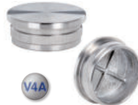
Endkappe V4A flach , hohl, mit Rändel, zum Einschlagen
