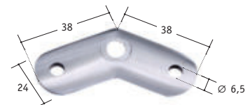
Anschraubplatte V2A, 135°, K240 geschliffen
