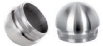
Endkappe V2A halbrund , hohl, gegossen, mit Rändel, zum Einschlagen
