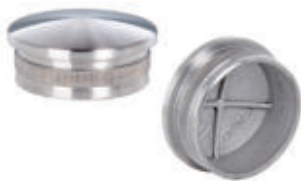
Endkappe V2A oval , hohl, gegossen, mit Rändel zum Einschlagen
