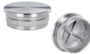
Endkappe V2A flach , hohl, gegossen, mit Rändel zum Einschlagen
