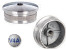
Endkappe V4A oval , hohl, mit Gewinde M8, mit Rändel, zum Einschlagen
