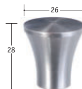
Relingstangenabschluss V2A, mit Sacklochbohrung
