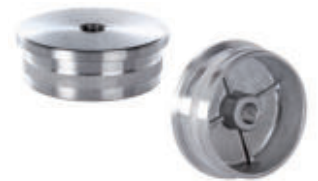
Endkappe V2A flach , hohl, gegossen, mit Rändel zum Einschlagen, mit Gewinde M8
