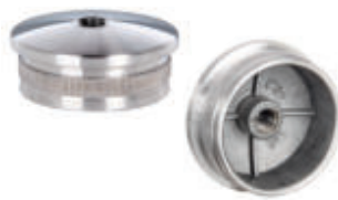
Endkappe V2A oval , hohl, gegossen, mit Rändel zum Einschlagen, mit Gewinde M8
