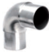
Rohrsteckwinkel V2A, 90°, rund , zum Einkleben, K240 geschliffen
