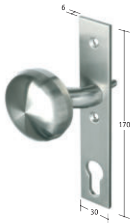
Türknoopf V2A, gekröpft, feststehend mit Kurzschild, Entfernung: 72 mm, PZ gelocht, rechts/links verwendbar, Lochabstand: 67 mm
