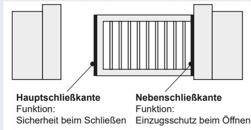
D.h.: Kontaktleisten, die in Schließbewegung auf ein Hindernis reagieren sollen, müssen (in Serie) an den Anschlussklemmen der Hauptschließkante angeschlossen werden.
