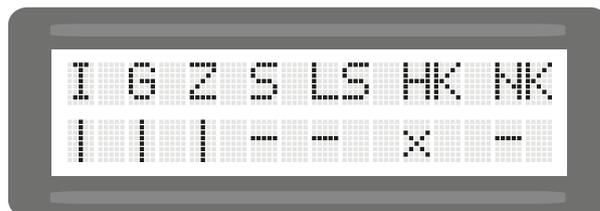
Impuls-, Gehtür- und ZU-Taster nicht ausgelöst. STOPP-Taster und Lichtschranke ausgelöst. Kontaktleiste (Hauptschließkante) fehlend oder defekt. Kontaktleiste (Nebenschließkante) ausgelöst.
