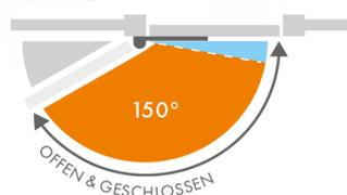
Max. 150°, abhängig von der Position des Torbands und des Torschließers
