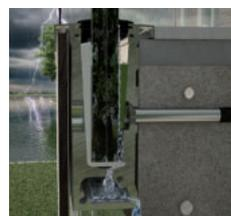
Wasser in Verbindung mit Kälte kann beim Einsatz von Ganzglasgeländern zu Problemen führen. Um die Funktionsfähigkeit auch bei widrigen Wetterverhältnissen gewährleisten zu können, sind sämtliche OnLevel-Glashalteprofile jeweils im Abstand von 1 m mit Entwässerungsöffnungen ausgestattet.
