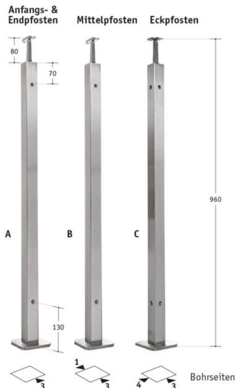
**Quadratpfosten V2A**, 40 x 40 x 2 mm, mit **fixem** Handlaufhalter, mit M8 Gewindebohrungen für Glasklemmen
