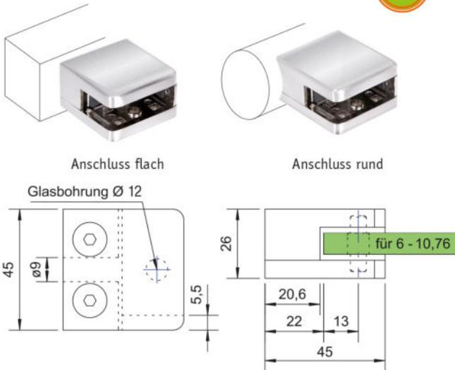
Glasklemme V2A/V4A mit ABZ, Modell 03, eckige Form (groß), für Glasstärke: 6,00 - 10,76 mm, VE = 4 Stück, inklusive Sicherungsstift & Sicherungsplatte
