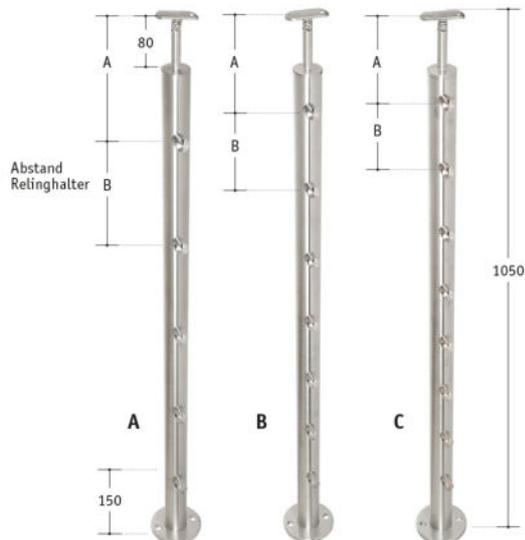
Rundpfosten V2A, 42,4 x 2,5 mm, mit **beweglichem** Handlaufhalter, mit Relinghaltern, mit Bodenplatte
