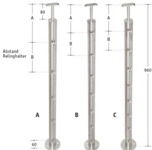
Rundpfosten V2A, 42,4 x 2,5 mm, mit **fixem** Handlaufhalter, mit Relinghaltern, mit Bodenplatte
