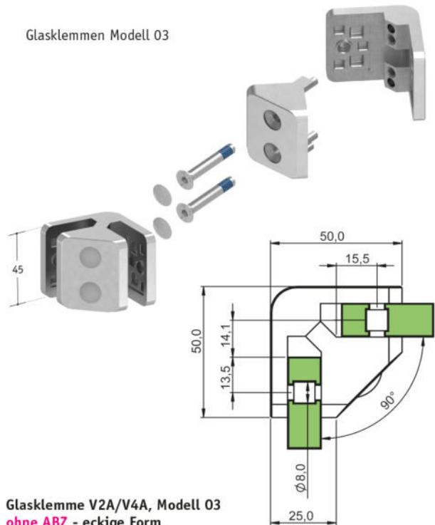
Glasklemme V2A/V4A, Modell 03 ohne ABZ - eckige Form für 90° Verbindung, für Glasstärke 1,5 mm - 10,76 mm
