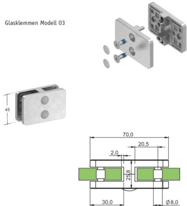
Glasklemme V4A, Modell 03 ohne ABZ - eckige Form für 180° Verbindung, für Glasstärke 1,5 mm - 10,76 mm
