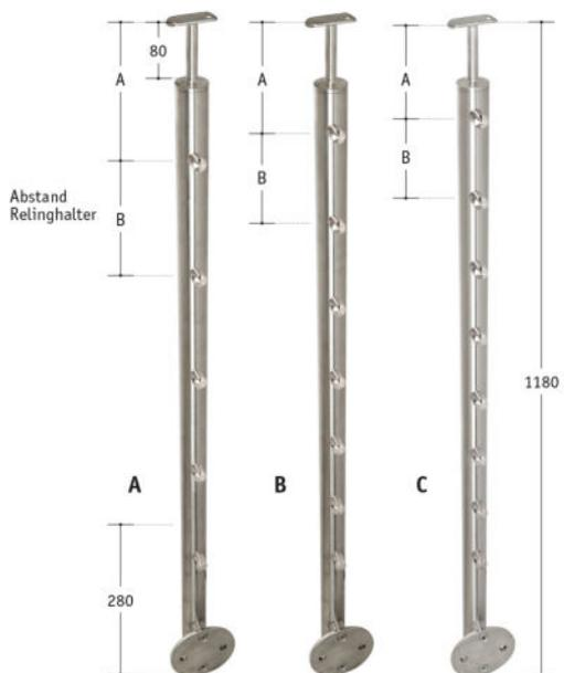
Rundpfosten V2A, 42,4 x 2,5 mm, mit **fixem** Handlaufhalter, mit Relinghaltern, mit seitlicher Platte
