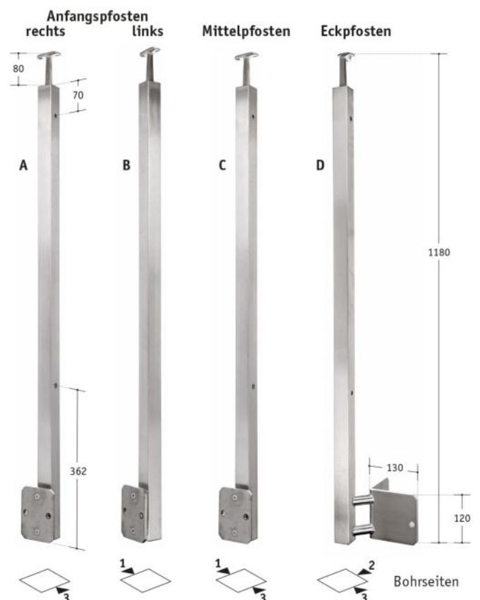
**Quadratpfosten V2A**, 40 x 40 x 2 mm, mit **fixem** Handlaufhalter, mit M8 Gewindebohrungen für Glasklemmen, mit seitlicher Platte
