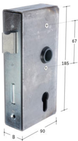
Einsteckschloss mit Schlosskasten , Serie 55, Entfernung: 72 mm, rechts & links verwendbar, 2-tourig.
