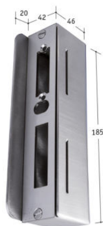
Anschlagkasten , inkl. Schließblech, Kastengehäuse mit Sollbruchstellen, Schließblech passend für elektrischen Türöffner Art. Nr. 963007 (s. S. 236). Durch Drehen des Schließbleches geeignet für Schlosskästen 30 & 40 mm, passend für Serie 55 & 60.
